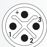
Штырьевая вставка, вид с контактной стороны
