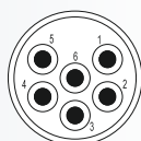
Штыревая вставка на контактной стороне
